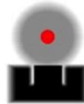
IMPACTO DE BALA CUANDO HAY UN ERROR ANGULAR EN LA ALINEACIÓN DE MIRA
